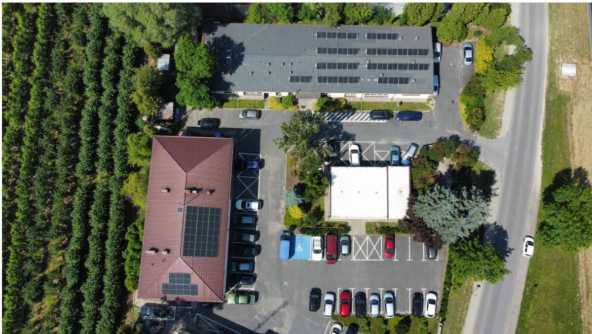
27. Montaż dwóch instalacji fotowoltaicznych na budynkach Urzędu Gminy Konopnica, jedna o mocy 14 kW druga 18 kW. Wartość inwestycji 139 974,00 zł.
